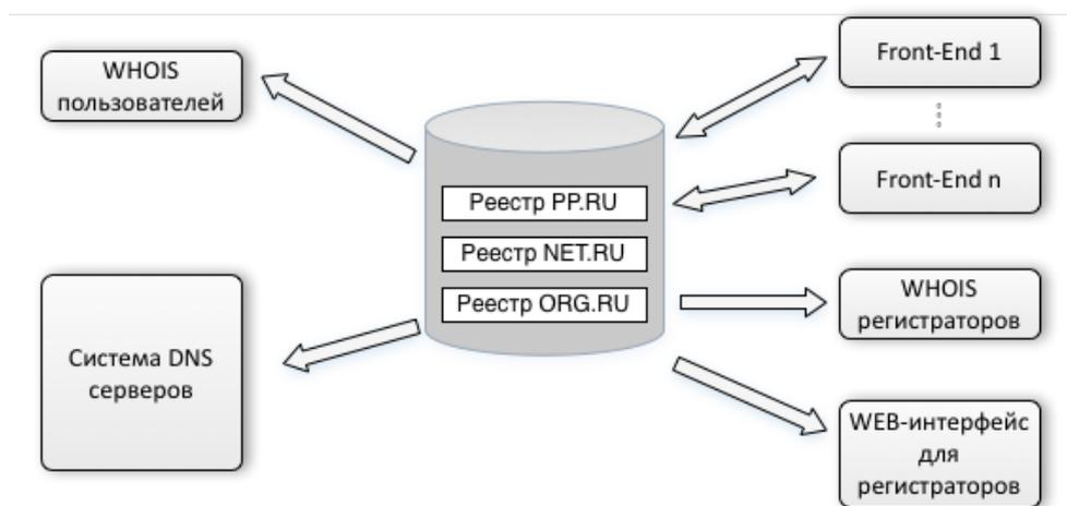
Рис. 1. Схема компонентов системы регистрации
