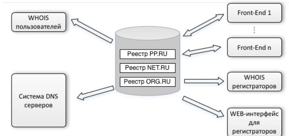
Рис. 1. Схема компонентов системы регистрации
